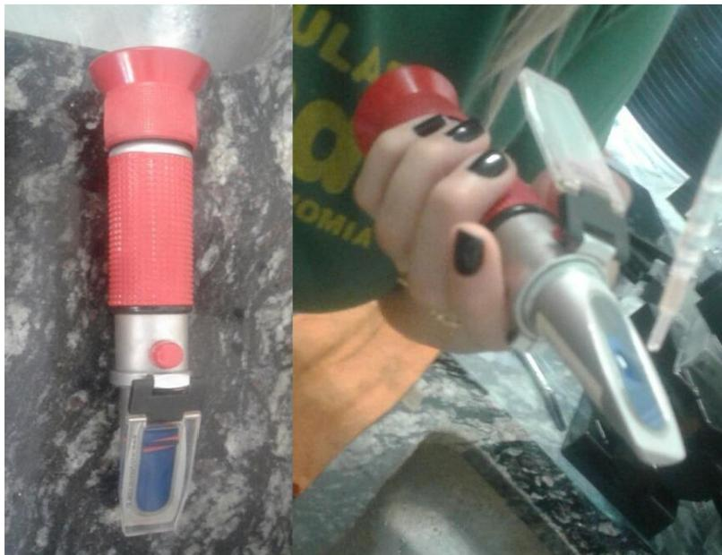
Figura 6.a. Refratômetro Digital. 6.b. Medição do °Brix. Fonte: Silva Nogueira, 2015.
