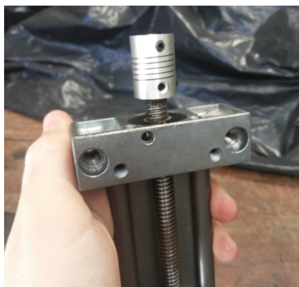
Figura 9: Acoplamento elástico entre motor de passos e fuso trapezoidal que fica dentro da caixa alinhadora (Marcação 1)
