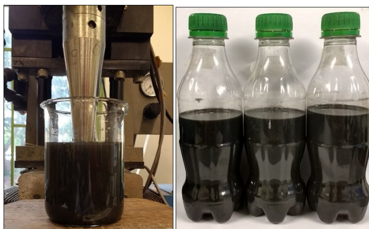
Figura 3.18 – Nanofluidos de MWCNT-Ag/EG: (a) síntese dos nanofluidos, (b) imagens dos nanofluidos após a síntese. Fonte: Fotografias da autora.
