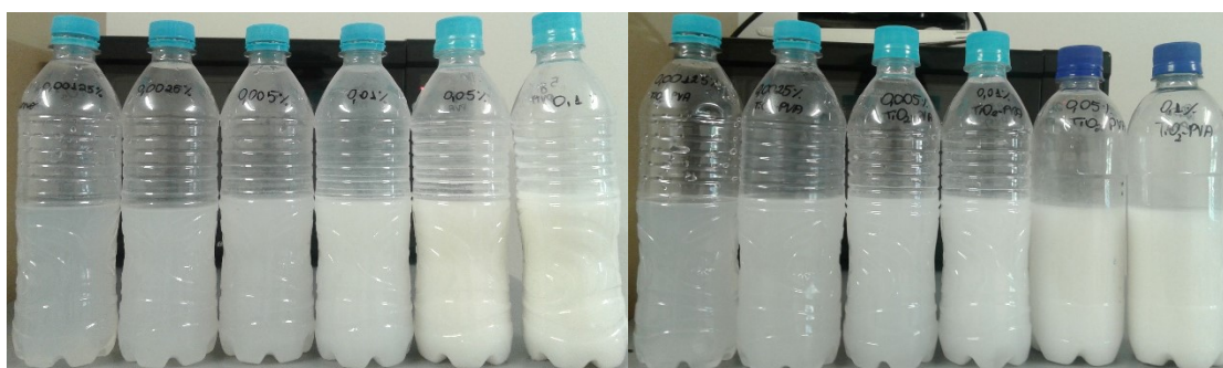
Figura 3.14 – Nanofluidos de \text{TiO}_2 -PVA/água após a síntese: (a) imagens dos nanofluidos \text{TiO}_2 -2,5PVA e (b) imagens dos nanofluidos \text{TiO}_2 -5PVA. Fonte: Fotografias da autora.
