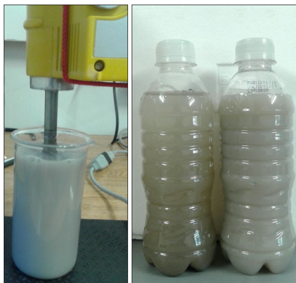
Figura 3.15 – (a) Síntese de Nanofluidos de Di-COOH/água (b) antes (esquerda) e depois (direita) da ultrassonicação. Fonte: Fotografias da autora.
