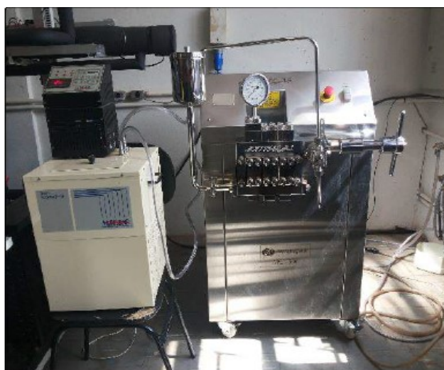
Figura 3.16 – Homogeneizador de alta pressão do LEST-nano (UFU). Fonte: Gómez, (2015).
