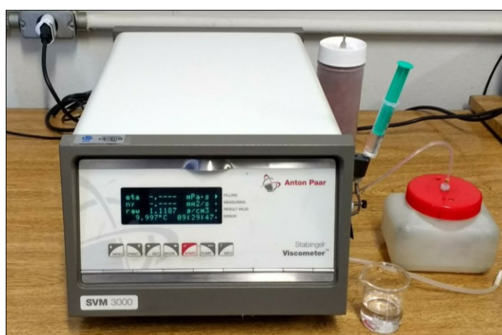
Figura 3.22 – Viscosímetro utilizado para medição da viscosidade de nanofluidos. Fonte: Fotografia da autora.
