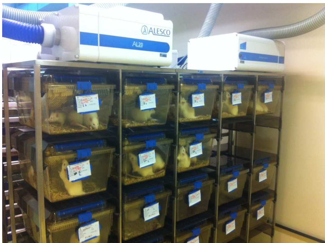
Figura 6: Rack ventilado e caixas de monitoração
