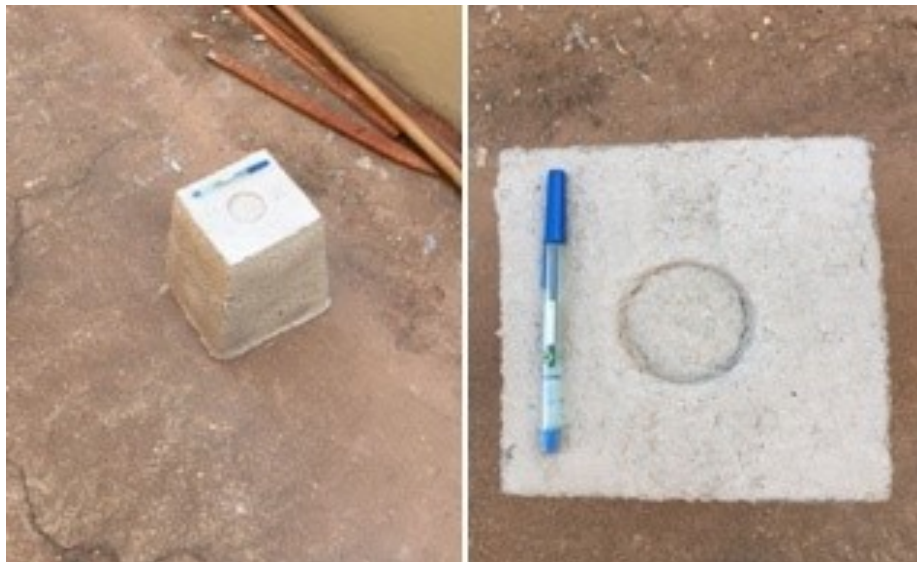
Figura 8- Marcos de concreto
