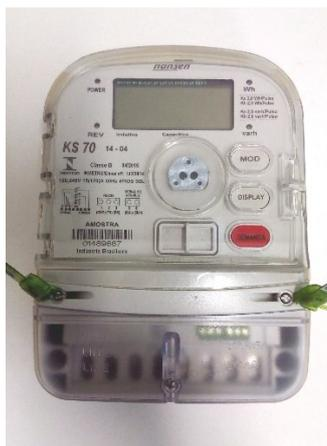
Figura 6.1 – Medidor de energia elétrica para cálculo da nova metodologia.
