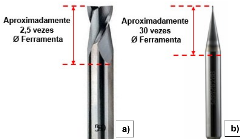
Figura 2.11 - Relação entre o comprimento real e o diâmetro da ferramenta em (a) ferramenta com \varnothing 4 mm e em (b) ferramenta com \varnothing 0,2 mm
