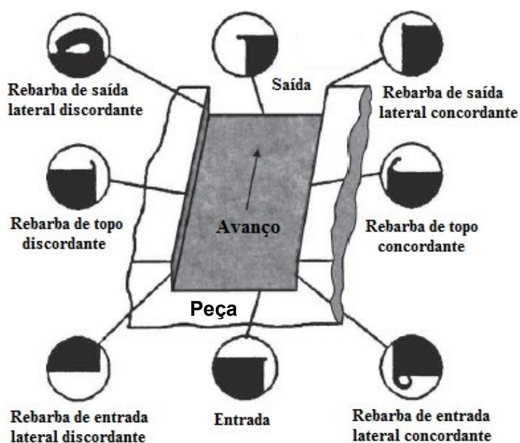
Figura 2.32 - Categorização das formas e localização da rebarba em uma operação de fresamento de topo (Adaptado de LEE; DORNFELD, 2002)
