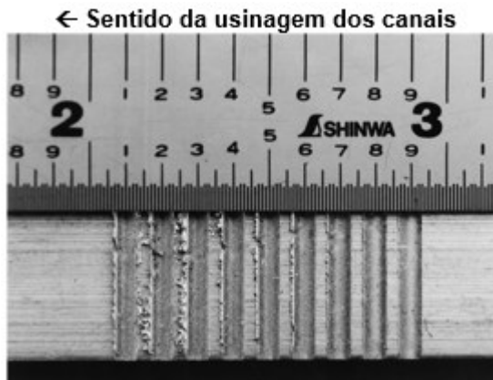
Figura 2.34 - Progressiva formação de rebarba ao longo do desgaste da ferramenta. *escala da régua em polegadas (BAO; TANSEL, 2000)
