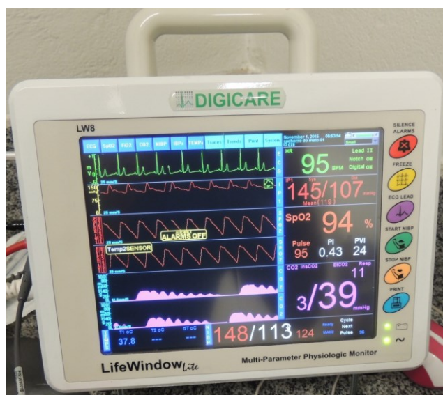
Figura 2. Imagem fotográfica de um monitor de multi-parâmetros (Digicare TMLifeWindowTMLite, Digicare Biomedical Technology, Inc., Boynton Beach, Flórida, Estados Unidos da América), observando-se na tela as referências aos parâmetros de frequência cardíaca, frequência respiratória, temperatura corporal e saturação parcial de oxigênio aferidos durante a contenção de um cachorro-do-mato adulto ( Cerdocyon thous ) pela associação: P1 – tiletamina, zolazepam, xilazina, atropina e azaperone; P2 – dextrocetamina, diazepam, xilazina, atropina e azaperone; P3 – cetamina racêmica, diazepam, xilazina, atropina e azaperone, em doses calculadas por meio de extrapolação alométrica interespecífica. (LAPAS/UFU, Uberlândia, Brasil).
