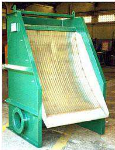
Figura 2.1.2 - Exemplo de peneira estática. Fonte: DOSAQ.
