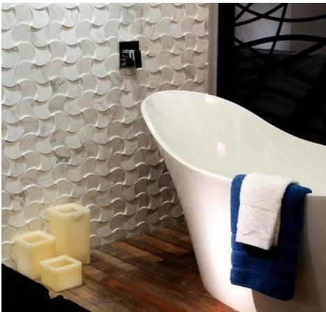
Possuem em sua composição resina PET e resíduos de pedra. Não necessitam de impermeabilizantes e podem ser perfeitamente utilizados em áreas molhadas. Possui alta durabilidade e baixa manutenção. Além disso, a limpeza pode ser feita com um pano úmido. (MORAES, 2017). Além destas características citadas, também é um produto com uma estética que valoriza o ambiente.
