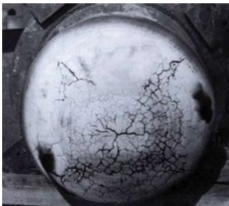
Figura 8 – Corrosão sob tensão em autoclave de aço inoxidável 304.
