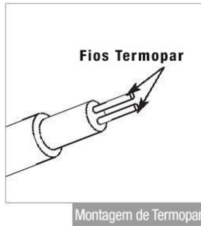
Figura 22 – Montagem de um Termopar
