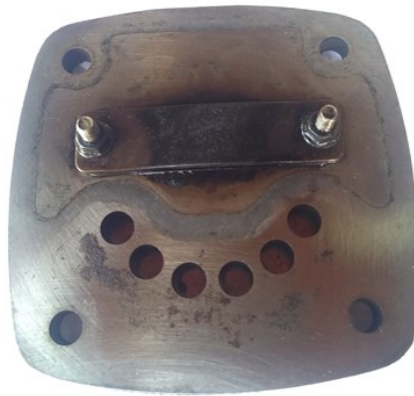
Figura 30 – Tampa inferior - Vista superior
