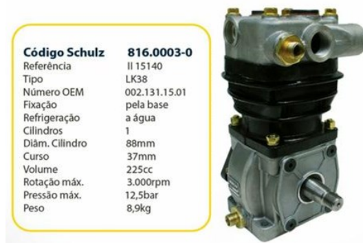
Figura 31 – Unidade compressora semelhante à utilizada na bancada
