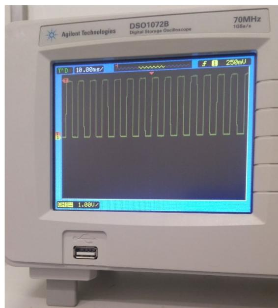
**Figura 32. Tensão de saída adquirida no estágio de ganho fixo.**
