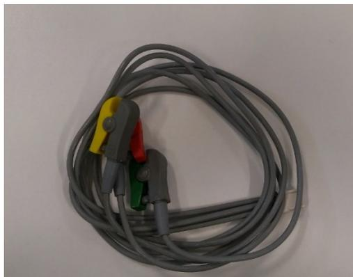
**Figura 18. Cabos com malha interna para condução do sinal EMG até a entrada do circuito de condicionamento.**
