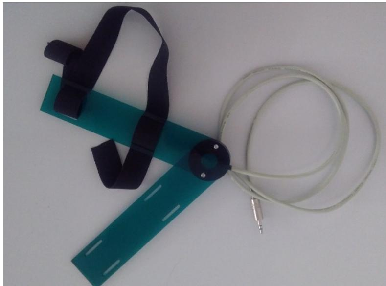
**Figura 34. Eletrogoniômetro projetado.**
