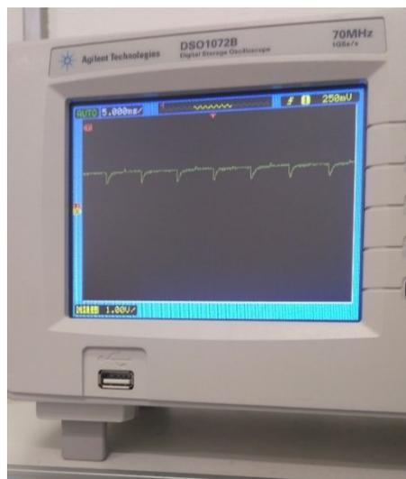
**Figura 30. Sinal captado na saída do estágio da fonte de alimentação.**
