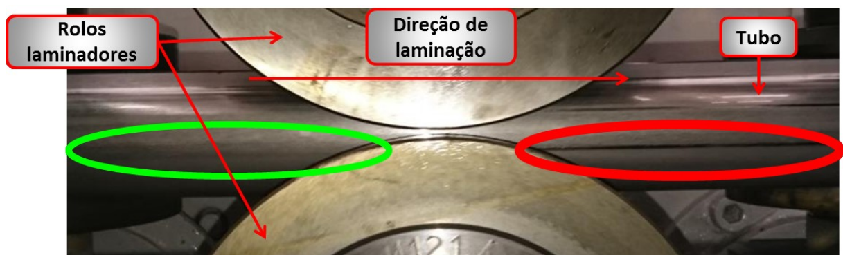
Figura 20- Surgimento das marcas na superfície externa do tubo durante uma das etapas de conformação.
