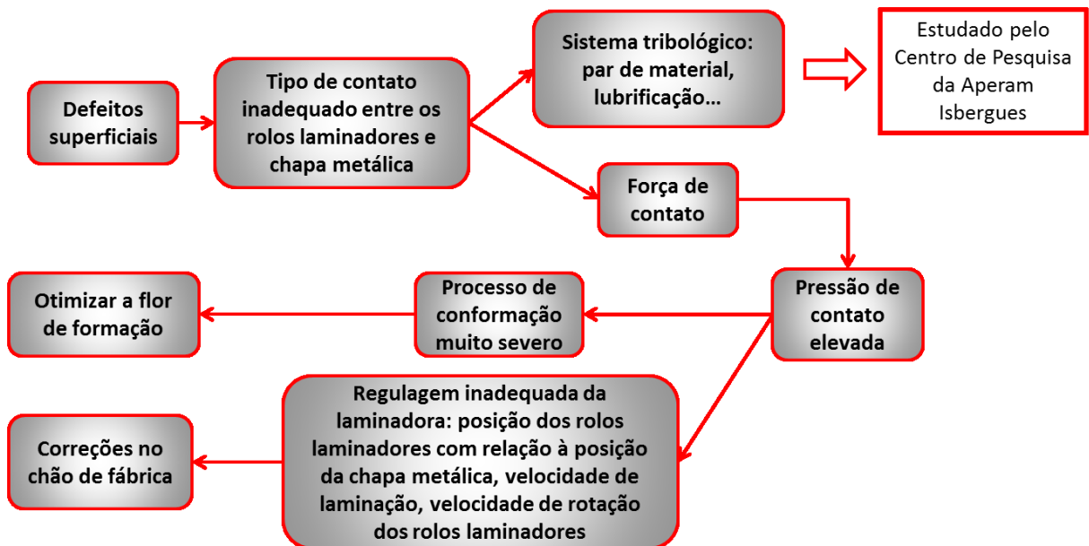
Figura 21- Esquema do princípio de surgimento das marcas nas superfícies dos tubos durante uma etapa de conformação.
