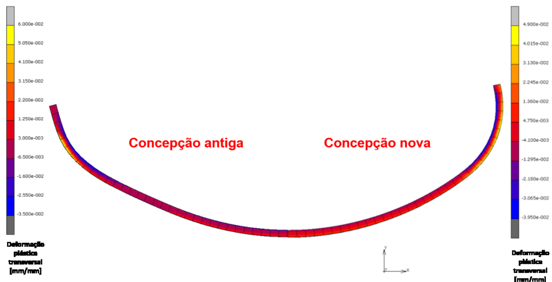
Figura 38- Comparação entre o formato do perfil da chapa metálica após 2ª etapa de conformação, incluindo uma análise da distribuição da deformação plástica transversal no perfil.
