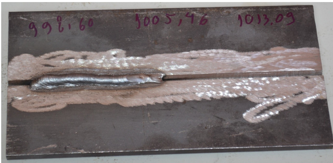
Figura 5.2 - Solda realizada sob a solda anterior
