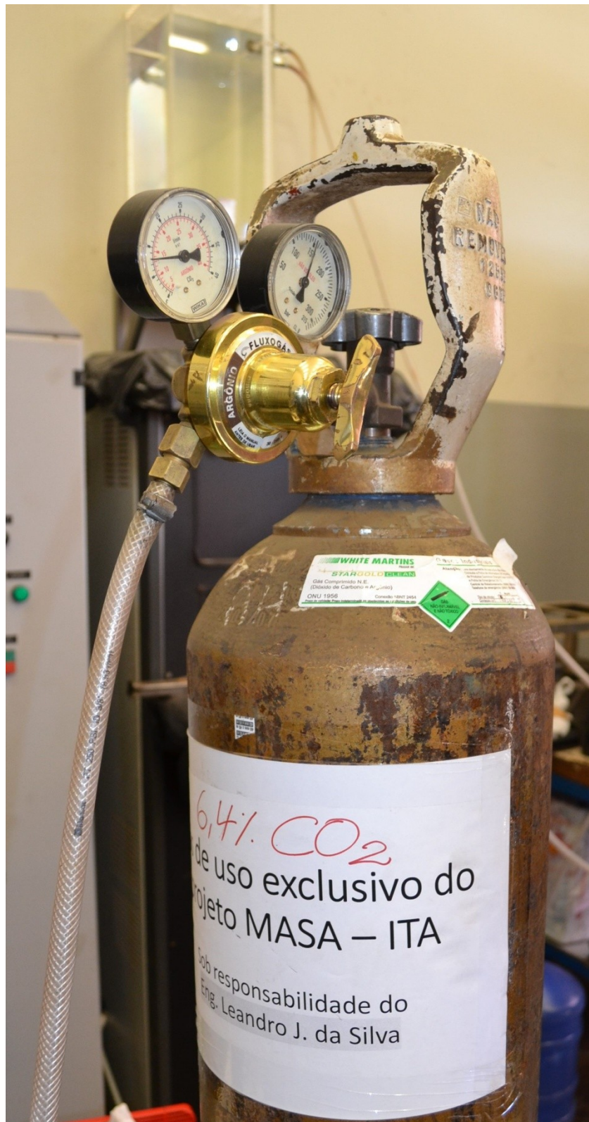
Figura 3.6 - Gás de proteção.
