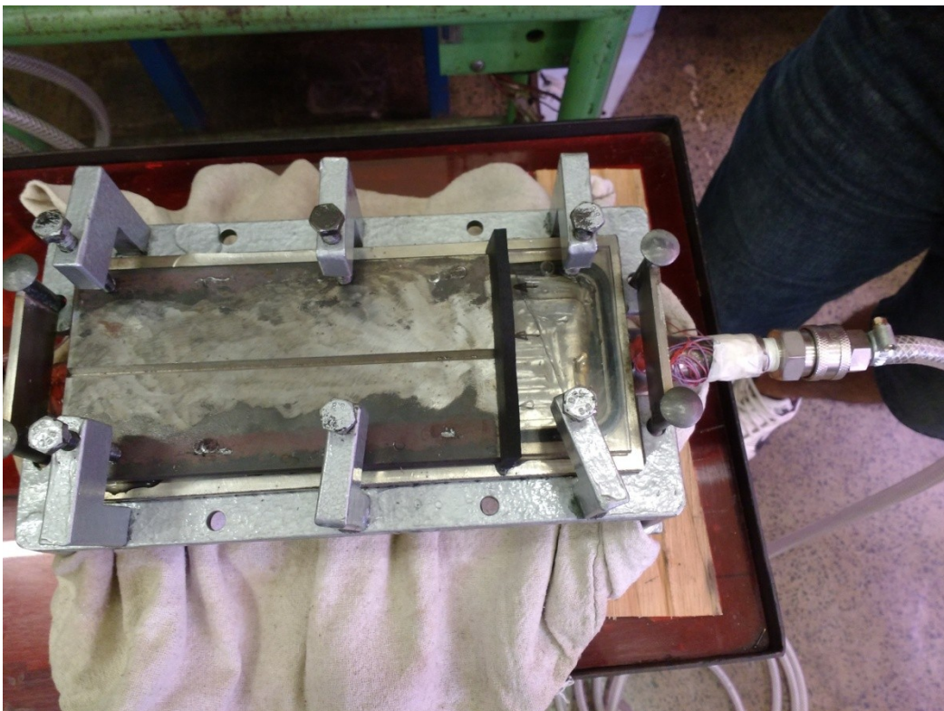
Figura 4.1 - Calorímetro já com a chapa de teste fixada.
