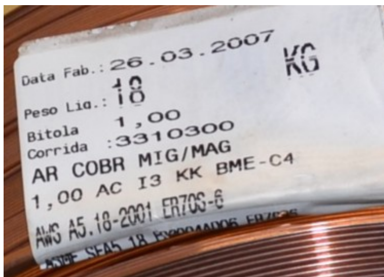
Figura 3.8 - Especificações do arame utilizado para soldagem MIG/MAG.
