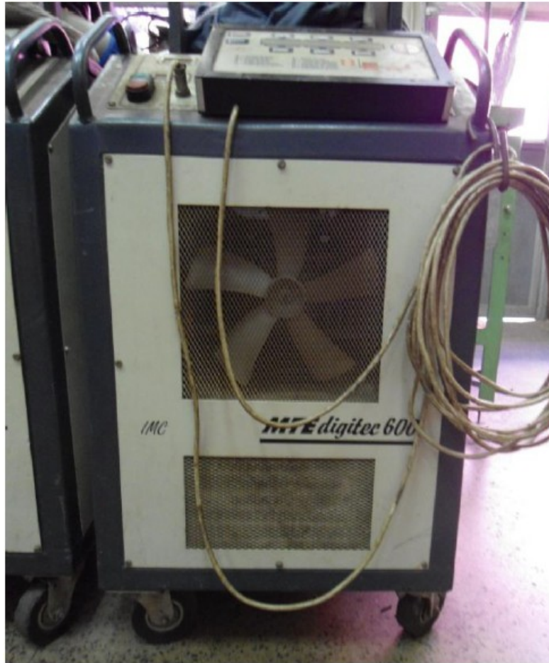
Figura 3.3 - Fonte utilizada no processo MIG/MAG.
