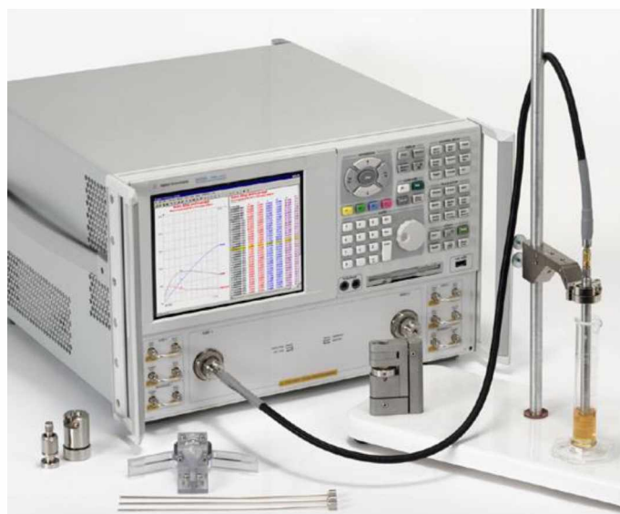
Figura 3.2 - Sensor Agilent para medição de propriedades dielétricas até 4,5GHz. Fonte AGILENT TECHNOLOGIES, 2011.
