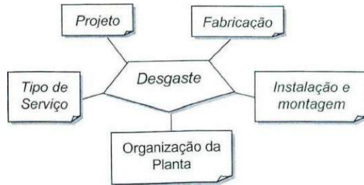
Figura 2.1 – Fatores que influenciam o desgaste em peças e componentes
