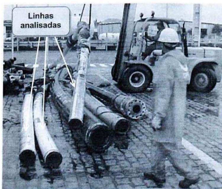
Figura 3.2 – Linhas flexíveis desgastadas de onde foram retirados os segmentos de revestimento polimérico
