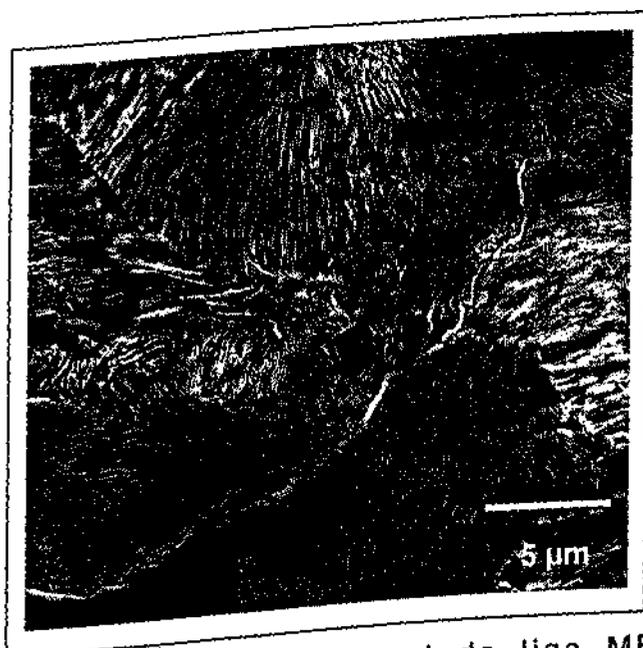
**Figura 3.16:** Aspecto microestrutural da liga MB1 no estado bruto de fusão, mostrando a formação perlítica com carbonetos nos contornos de grão da antiga austenita.
