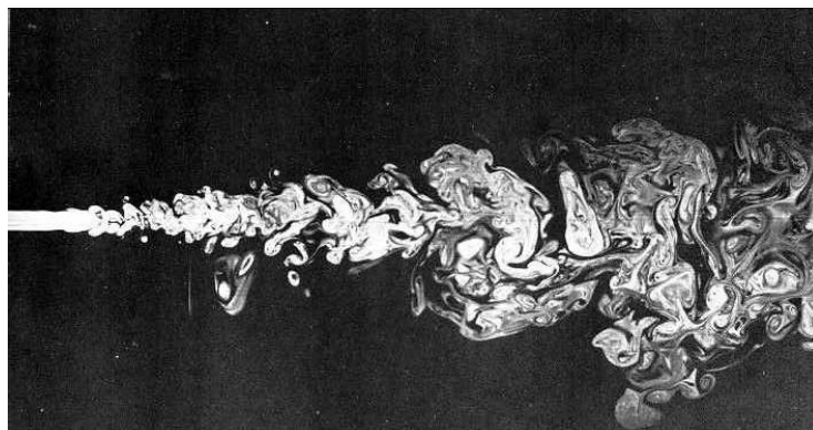
Figura 1 - Visualização do escoamento no plano de simetria de um jato de água axissimétrico, Re \approx 2300 (VAN DYKE, 1982).
