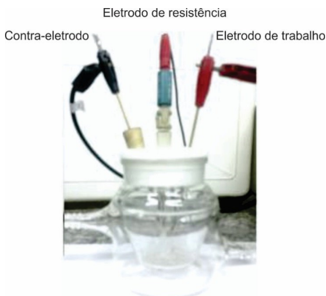
Figura 19 – Célula eletroquímica convencional utilizada para as sínteses e caracterizações eletroquímicas dos compósitos condutores e seus materiais constituintes.
