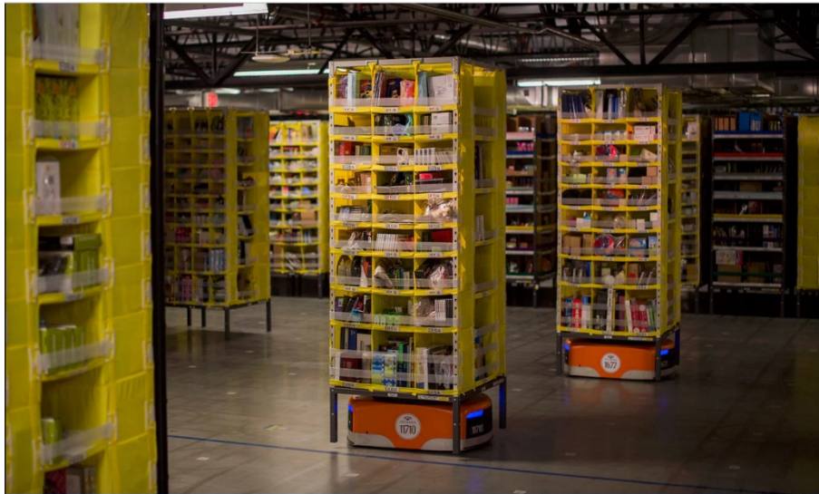
Figura 1.2. Robôs móveis responsáveis pela movimentação de inúmeras prateleiras de produtos em um dos armazéns da empresa Amazon (BERGER, 2014)
