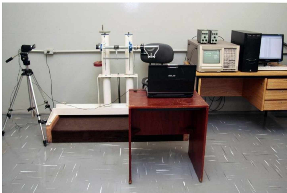
Figura 5.10 – Aparato experimental e instrumentação utilizada na estimativa da rigidez do braço.
