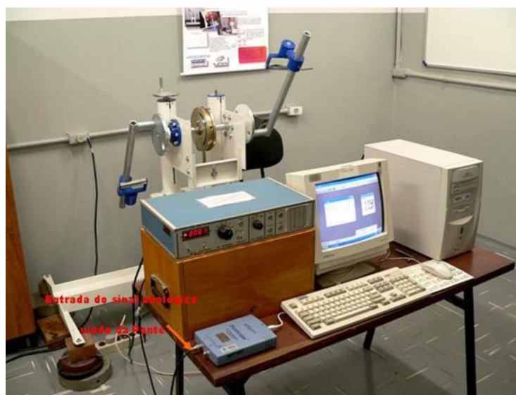
Figura 5.2 – Torquímetro construído para obtenção da curva de torque disponível no braço (SIQUIEROLLI, 2007).
