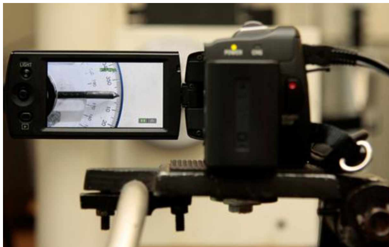
Figura 5.12 – Sistema de feedback utilizado para manutenção de força constante.
