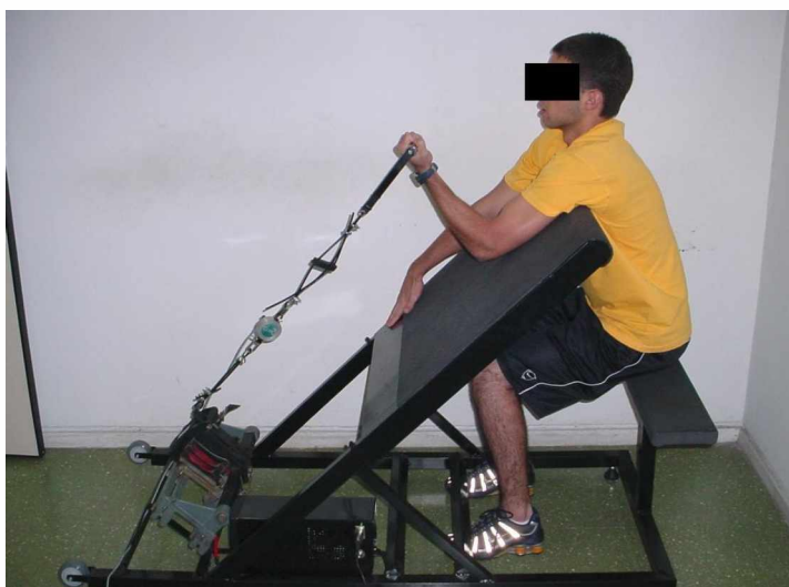
Figura 2.14 – Equipamento utilizado para aplicação da vibração mecânica na direção do encurtamento muscular em exercício isométrico. (Fonte: SILVA et al. , 2008).
