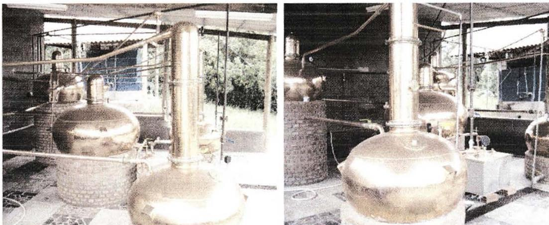
Fotos: engenho recém construído, alambiques, modernos atendendo as normas da AMPAQ, aquecidos a vapor. Como podemos ver nas fotos o contato humano é reduzido a quase zero. A cachaça escoa por canos instalados na construção, que leva o produto até o envasamento. (Acervo particular).
