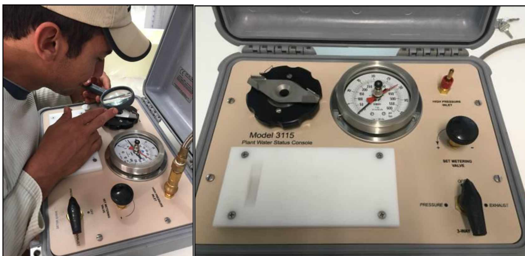
FIGURA 5. Avaliação do potencial hídrico foliar ( \Psi ) com o uso da câmara de Scholander realizadas na manhã do dia 31/08/2016.
