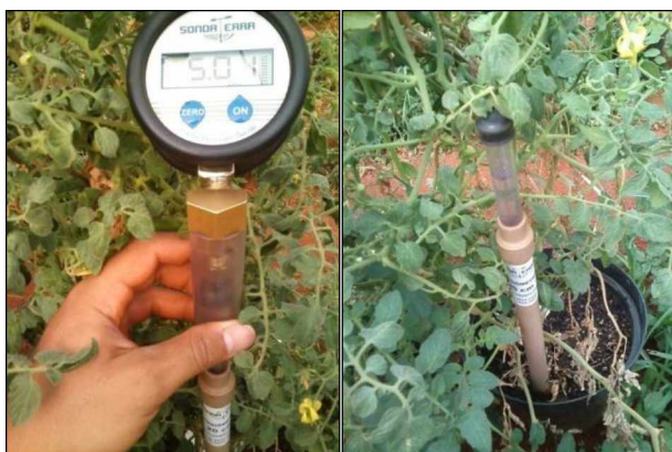
FIGURA 3. Tensiômetros instalados em cada parcela 20 dias antes da avaliação (11/08/2016) para monitoramento da tensão de água no substrato.
