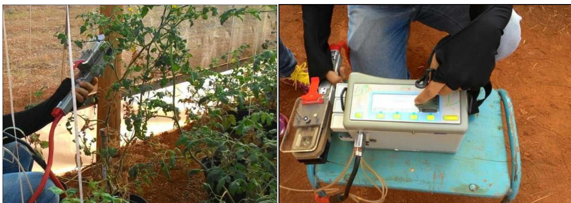
FIGURA 4. Análise das trocas gasosas nos tomateiros submetidos ao estresse hídrico com o uso do IRGA no dia 31/08/2016.
