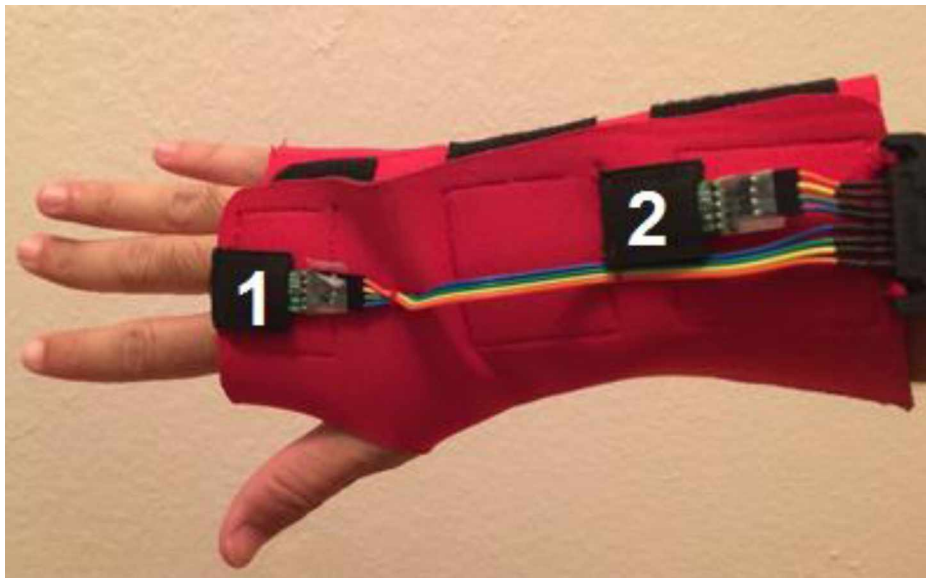
Figura 1- Sensores inerciais fixados na luva customizada para a mensuração do movimento do punho. O sensor 1 é posicionado na mão, enquanto o sensor 2 é posicionado no antebraço.
