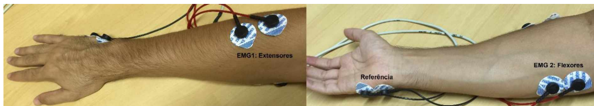
Figura 2 - Eletrodos de EMG posicionados nos músculos extensores (EMG 1) e flexores (EMG 2) do punho. Os eletrodos de referência são posicionados na mão do voluntário.
