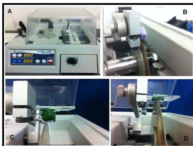
Figura 4. A- máquina de cortes seriados Isomet 1000; B- corte perpendicular para remover a haste metálica; C- corte para determinação da largura das barras; D- corte para determinação da espessura das barras.
