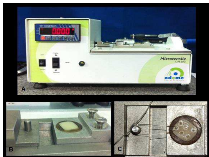
Figura 10. A- Máquina de ensaios mecânicos utilizada para o teste de microcisalhamento; B- cerâmica posicionada na máquina de ensaios; C- fio ortodôntico em posição alinhada à direção da força de aplicação de carga.
