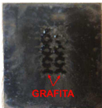
Figura 4.6 - Peça de ferro fundido cinzento submetida ao MECT para uma Dfp de 100 \mu\text{m} , um tempo de 60 s e uma tensão de 30 V. As regiões escuras correspondem a depósitos de grafita nas regiões onde deveria se concentrar a dissolução anódica.
