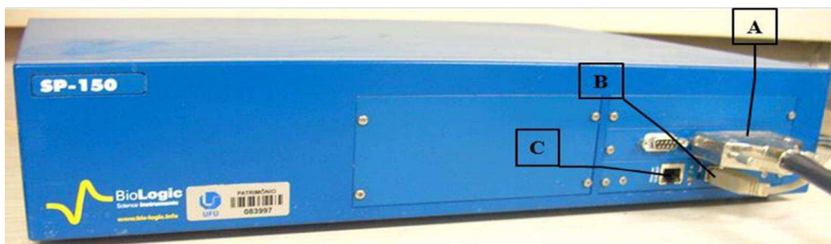
Figura 3.2 – Potenciostato BioLogic SP150. A) Saída de sinal potencial e aquisição de sinal de corrente da célula eletroquímica. B) Saída de dados para o processamento por porta USB. C) Saída de dados para processamento por porta Ethernet. Adaptado de (ARDILA, 2013).
