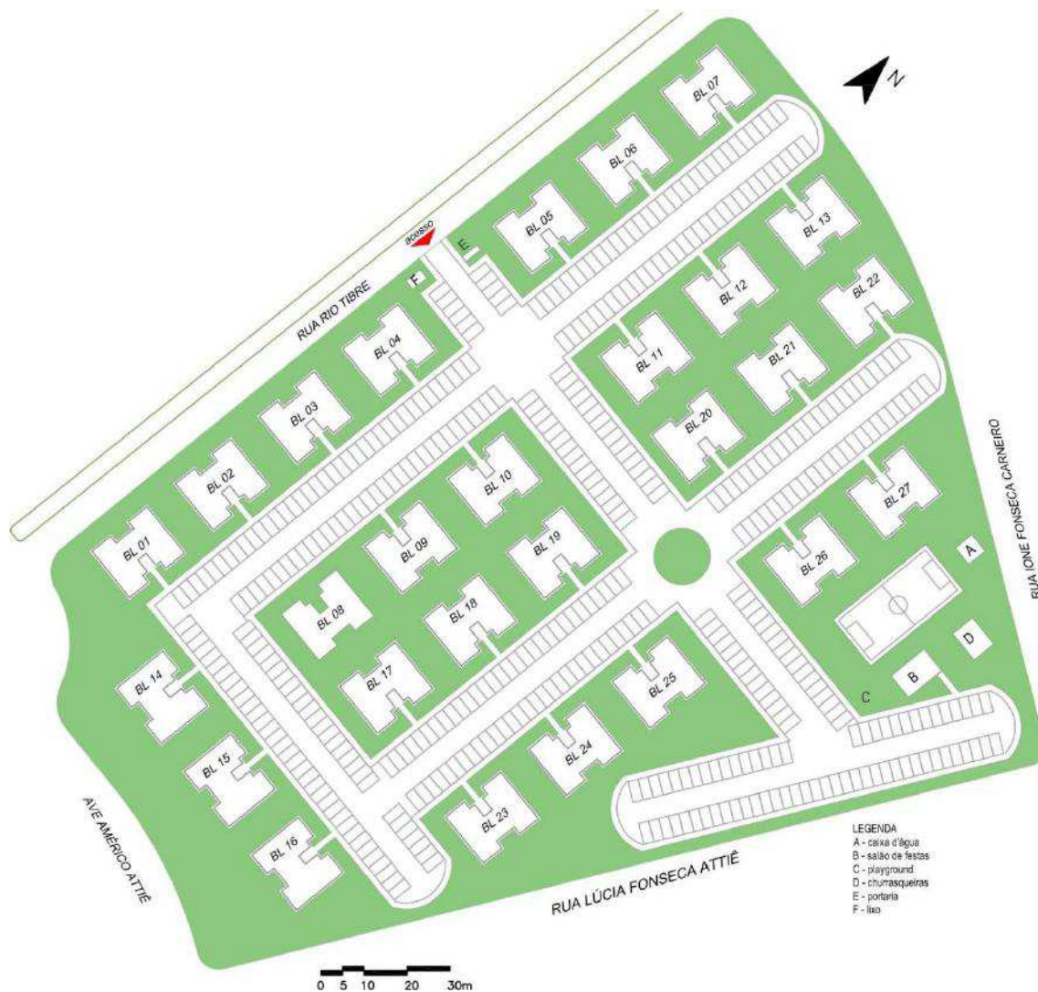
Figura 21. Planta de implantação do Residencial Mangabeira – em verde estão indicadas as áreas permeáveis.
