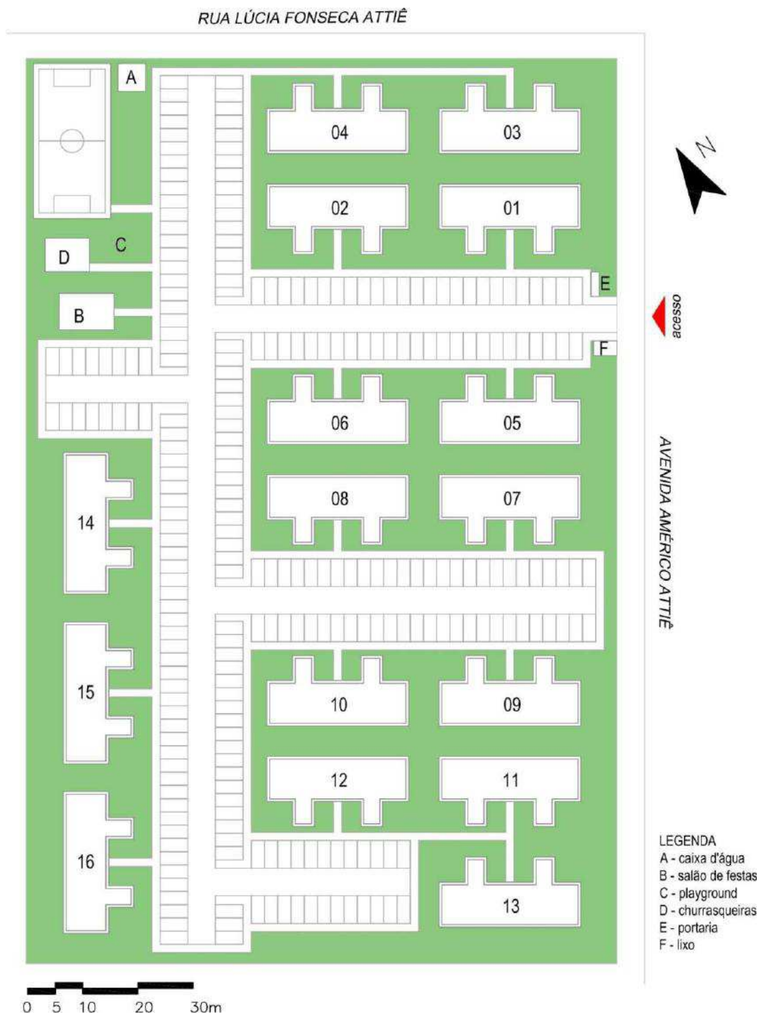
Figura 25. Planta de implantação do Residencial Buriti – em verde estão indicadas as áreas permeáveis.
