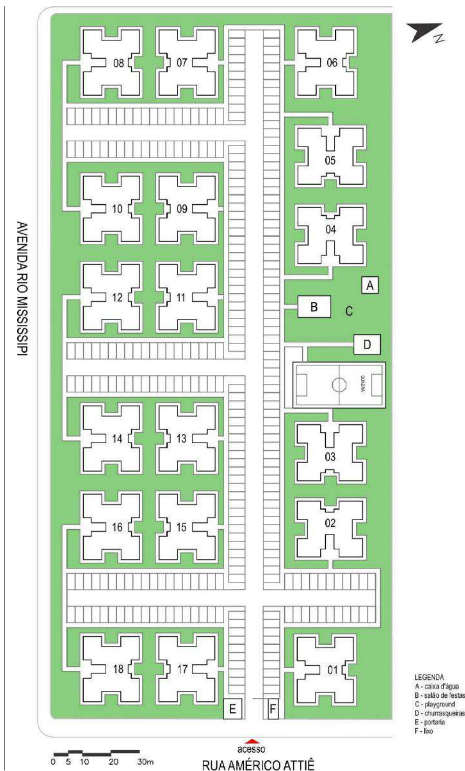
Figura 31. Planta de implantação do Residencial Gravatá – em verde estão indicadas as áreas permeáveis.
