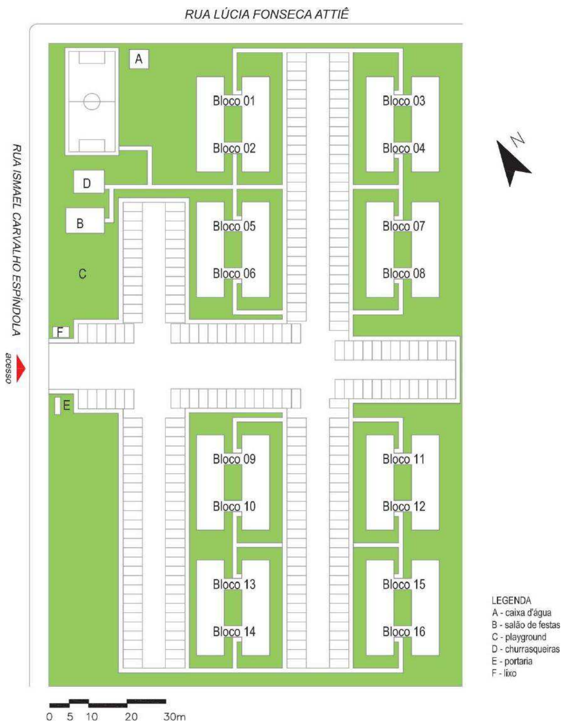
Figura 23. Planta de implantação do Residencial Palmeira Real – em verde estão indicadas as áreas permeáveis.
