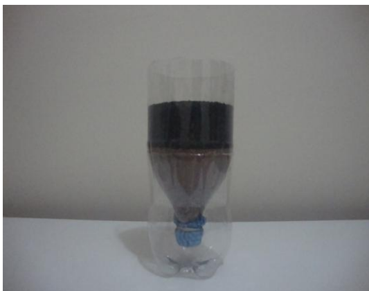
Foto 6 – Filtro com as camadas de cascalho, areia e carvão.
