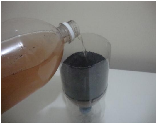
Foto 21 – Depositando água barrenta para filtração.
