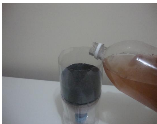
Foto 7 – Depositando água barrenta para filtração.
