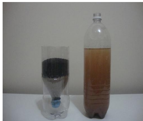
Foto 20 – Depositando água barrenta para filtração.
