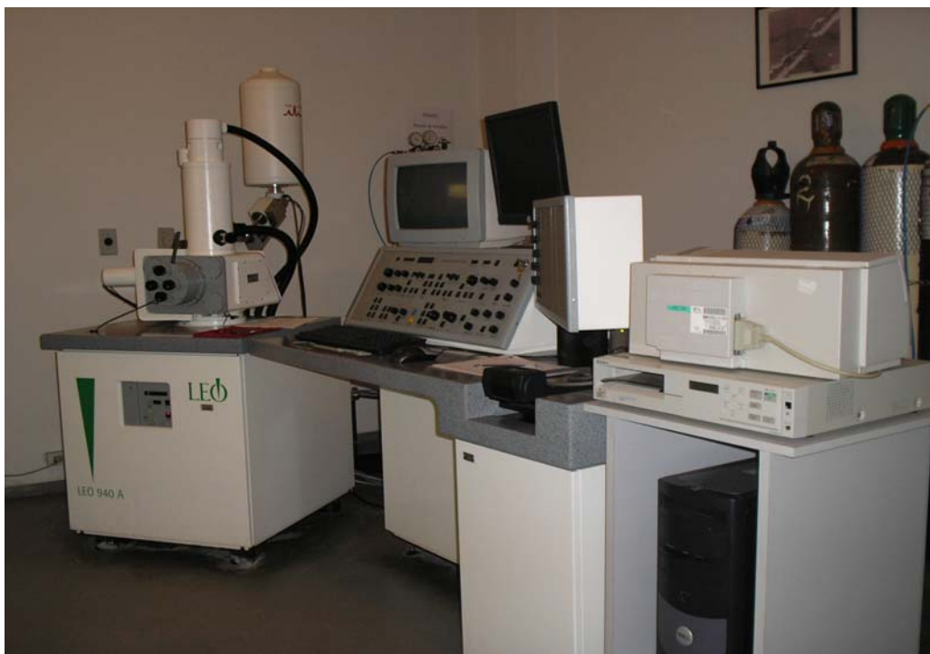
Figura 14. Microscópio eletrônico de varredura LEO modelo 940A, marca ZEISS.
