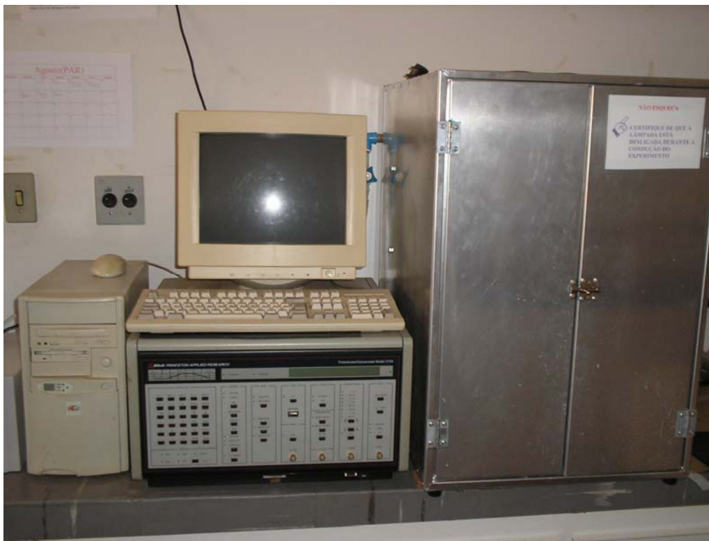
Figura 13. Potenciostato/galvanostato PAR modelo 273A.
