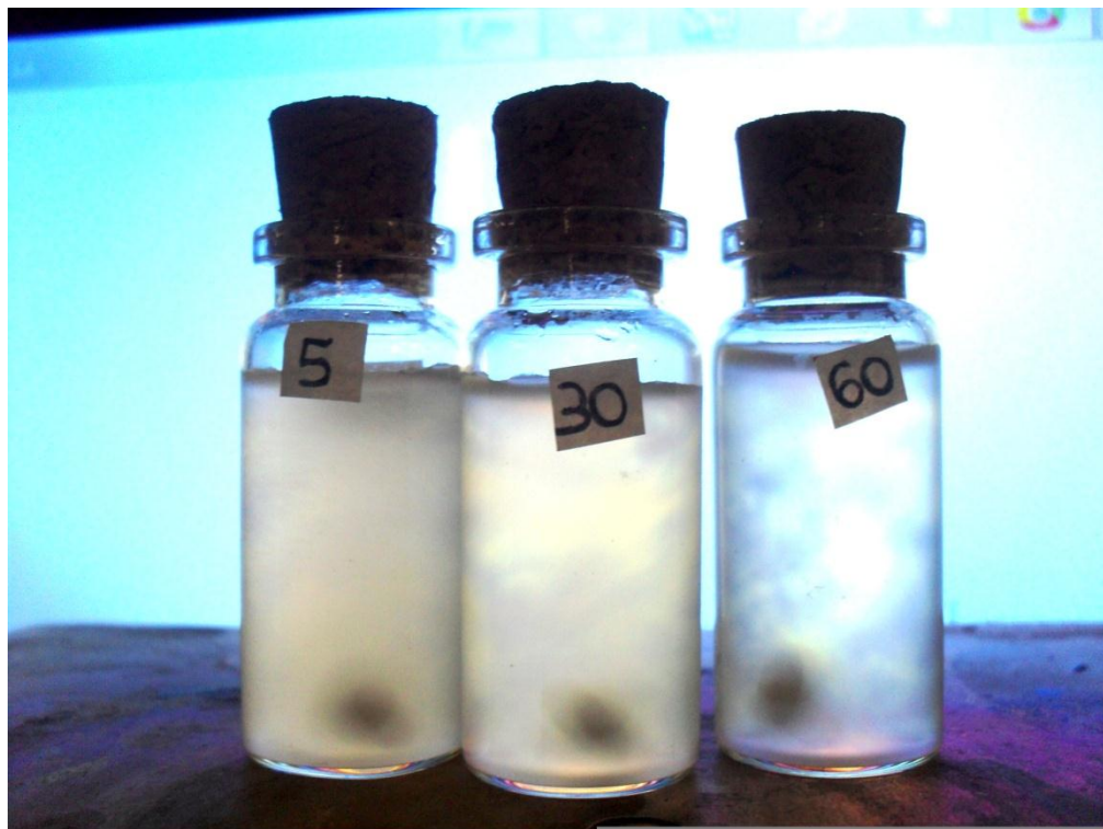
Figura 23 – Fotografia das suspensões aquosas de CNPL 5 , CNPL 30 e CNPL 60 observados entre polarizadores cruzados mostrando a formação de domínios birrefringentes.
