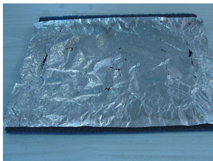
Figura 8: Mapa de maior intensidade ultrassônica no banho de ultrassom.
