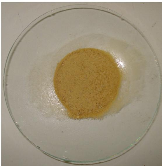
**Figura 26:** Sulfato de acetato de celulose, obtido através da reação de acetosulfonação simultânea da celulose extraída do bagaço de cana-de-açúcar.
