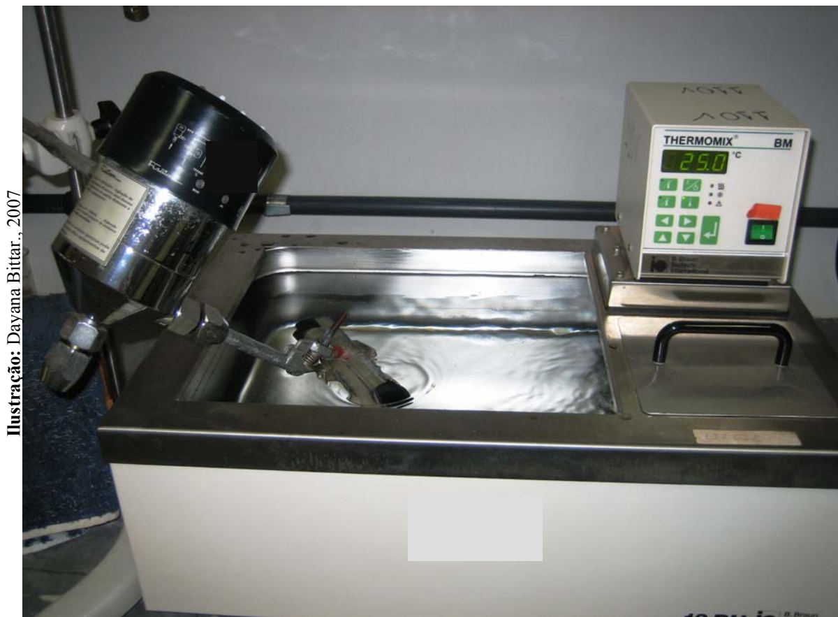
Figura 3: Sistema de agitação por tombamento.
