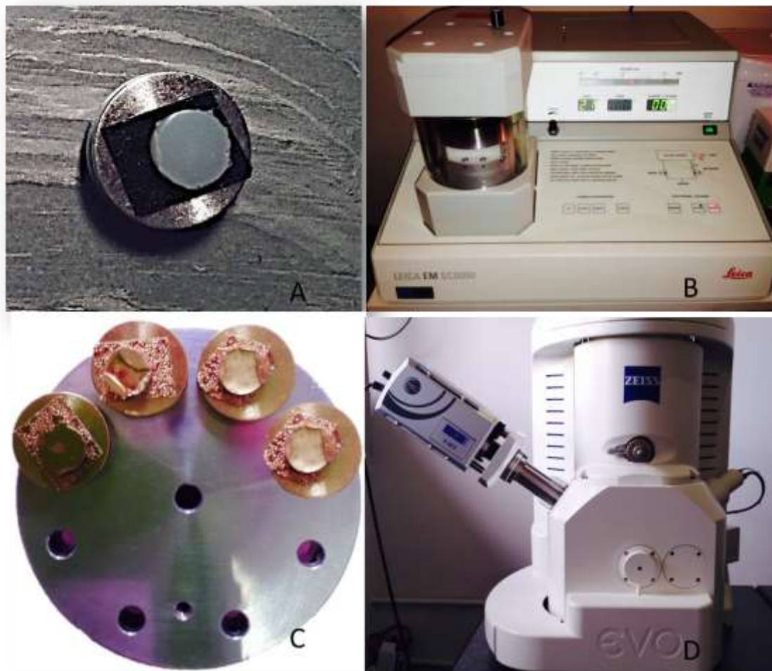
Figura 8. A- Amostra fixada em stub metálico; B- Metalizador responsável pelo recobrimento em ouro das amostras; C- Amostras recobertas em Ouro; D: Equipamento EDS acoplado ao MEV.
