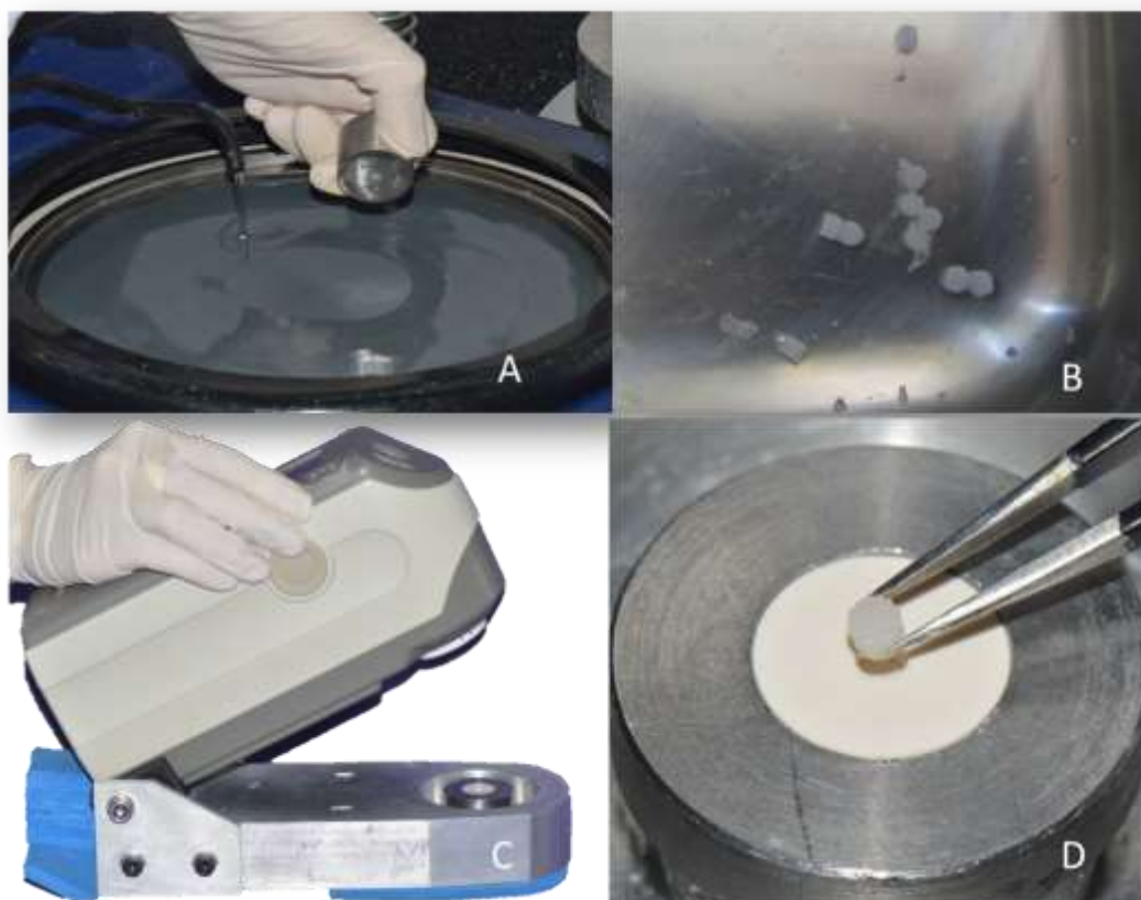
Figura 6. A- Polimento das amostras em lixas de carbeto de silício; B- amostras imersas em ultrassom; C- Espectrofotômetro (CM-2600d, Konica Minolta, Osaka, Japão); D- Amostra sendo inserida em Espectrofotômetro.
