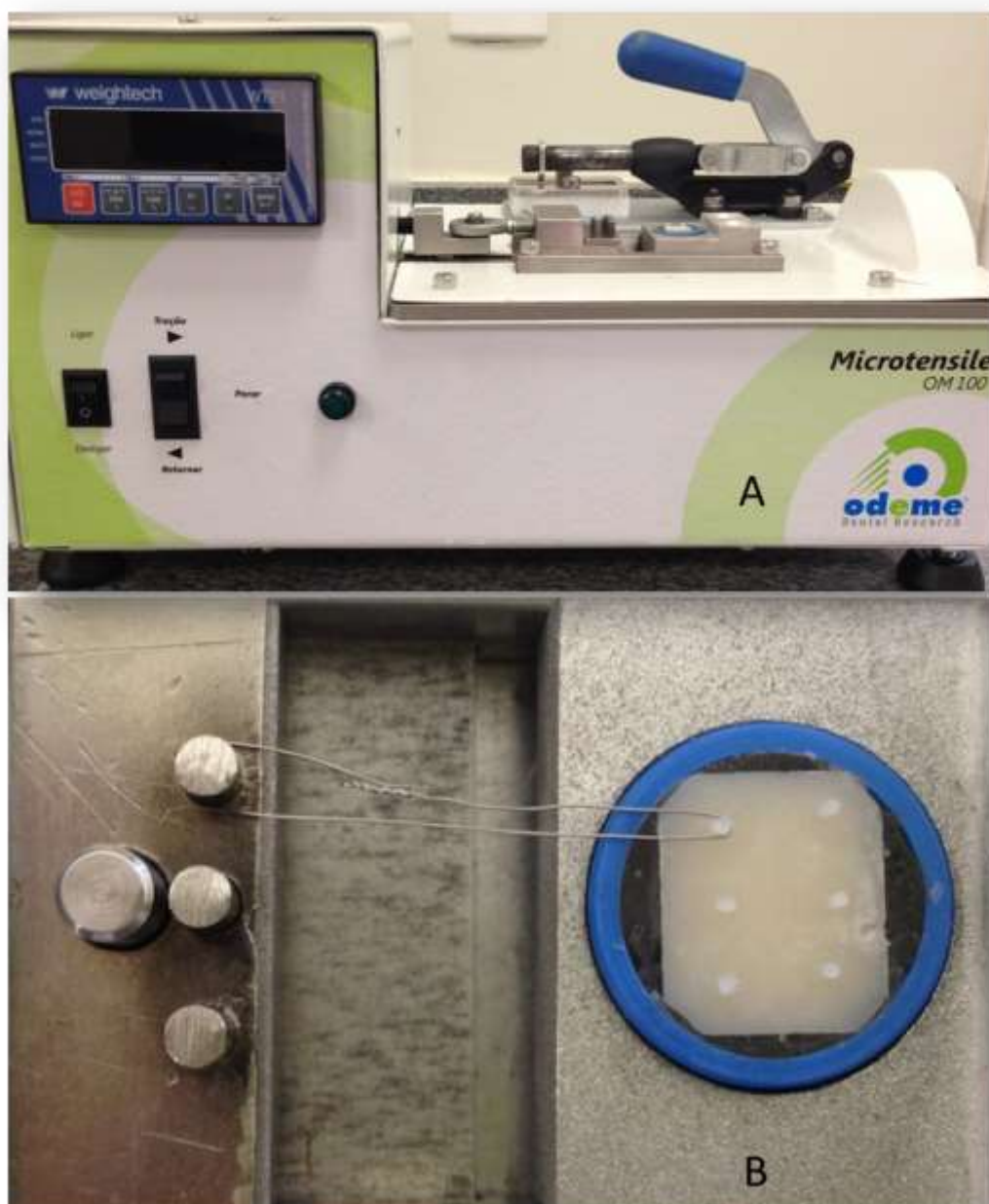
Figura 12. A- Máquina de ensaio da resistência de união à microtração/microcisalhamento (OM100, Odeme Dental Research); B – Bloco de cerâmica posicionado em equipamento e submetido a força de microcisalhamento por meio de fio ortodôntico para amarelo de 0.2 mm de espessura (NiCr, Morelli).
