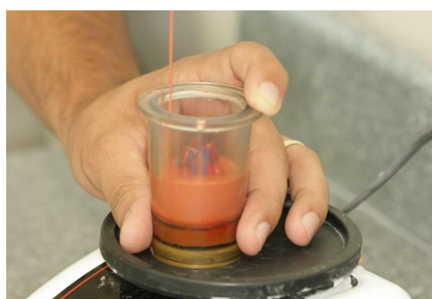
Figura 10. Manipulação do revestimento sob vibração.
