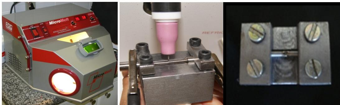
**Figura 03:** a) Aparelho de solda TIG Micromelt; b) Tccha da solda Plasma com o eletrodo de tungstênio encostado no corpo de prova a ser soldado; c) Corpo de prova soldado
