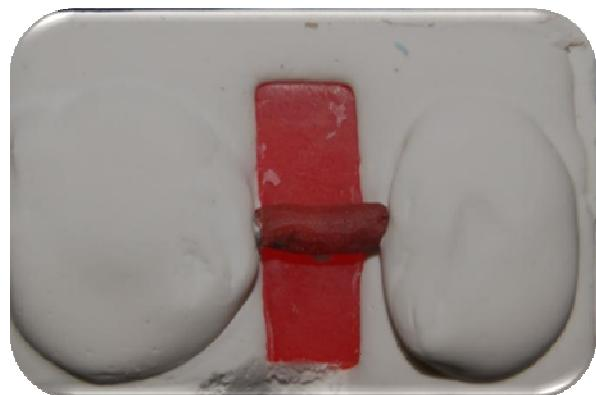
**Figura 04:** a) corpo de prova soldado com resina acrílica auto-polimerizável antes de ser levado ao forno
