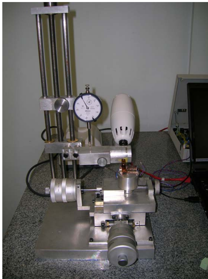
Figura 8. Aparelho de mensuração de contração de polimerização e deflexão de cúspide.
