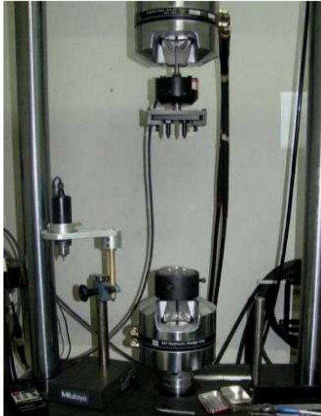
Figura 4: Pode-se observar à esquerda da figura o torquímetro sendo suportado pelo dispositivo confeccionado para realização das leituras. Na parte superior o dispositivo de aplicação da carga posicionado na célula de carga e abaixo o modelo posicionado em seu suporte preso à garra da MTS 810.
