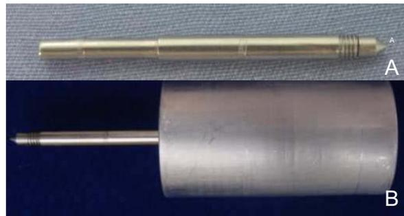
**Figuras 10** - A) Pino aplicador de esforços. B) Cilindro em alumínio com o extensor do aplicador de esforços.
