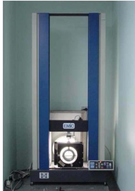
**Figura 2**– Máquina de Ensaio Universal com o Polariscópio.
