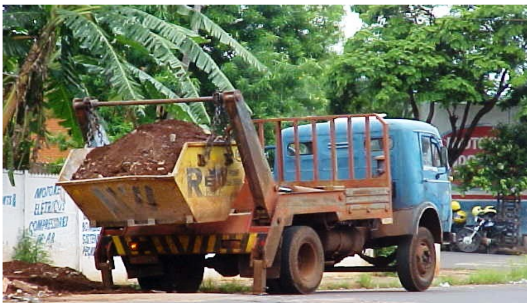
Figura 42. Caçamba de 6 m 3 recolhendo entulhos no bairro progresso, Ituiutaba (MG), junho/2006.
