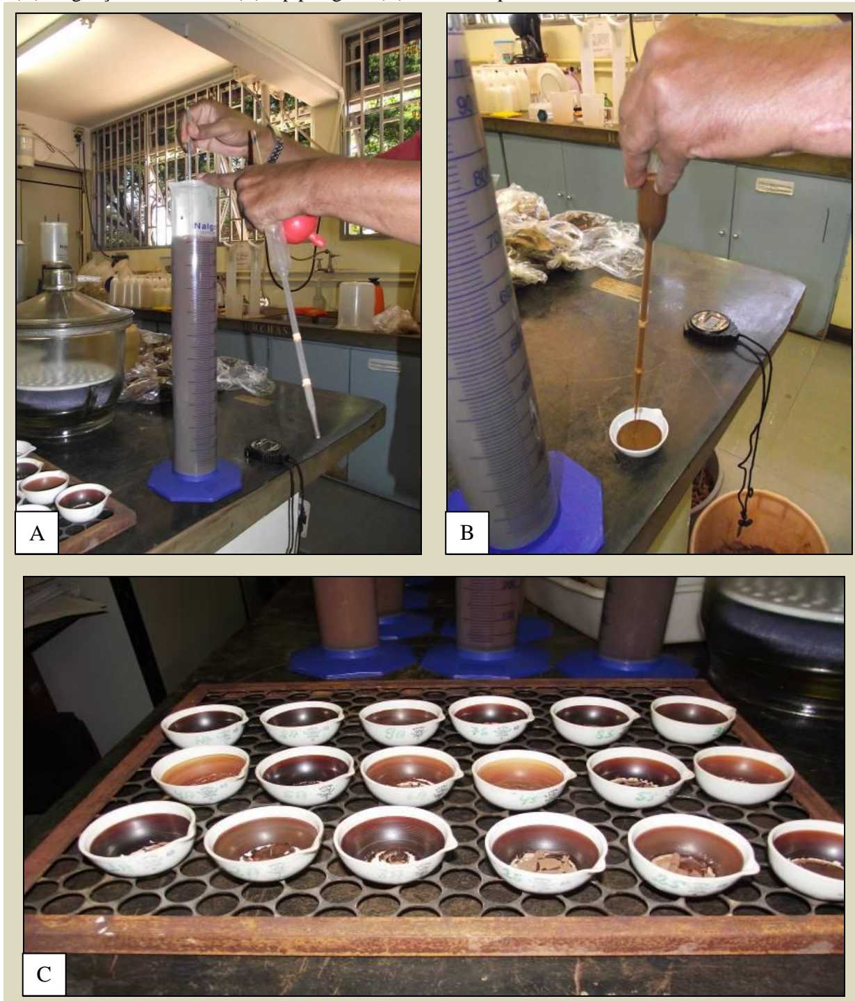
Figura 17: Processo de separação de silte e argila. (A) – agitação da amostra; (B) – pipetagem; (C) amostras após saírem da estufa.
