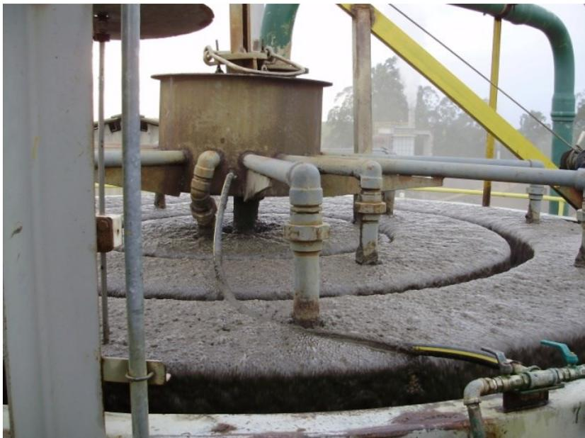
Foto 10: Última fase da flotação. Detalhe da cor acinzentada do minério. Autor: SILVA, J.F. 6/2009
