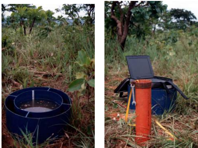
Figura 25 – Ensaio de Duplo Anel (esquerda) e Open End (direita) – porção Norte Fonte: Haesbaert e Costa, 2000
