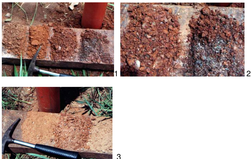
Figura 29 - Amostragem do solo na porção Centro-Oeste da área, obtida por tradagem:
