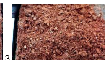
Figura 27 - Amostragem do solo na porção norte da área, obtida por tradagem:
