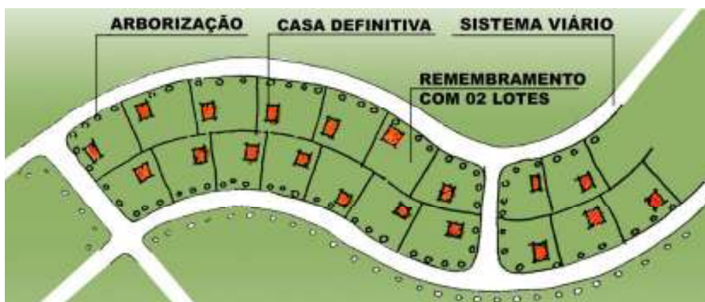
FIGURA 43: Vila de operação - Remembramento dos lotes e desmontagem das casas provisórias. FONTE: GONÇALVES & OESTREICH, 1985. Adaptação: GUERRA, M.E.A., 2007.
