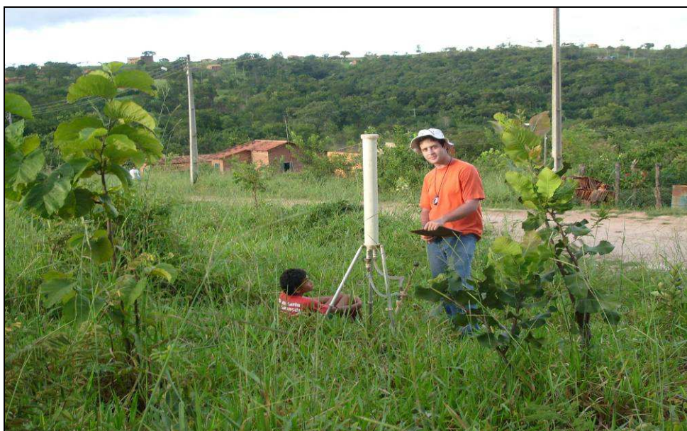
Figura 03 - Caldas Novas: utilização do Permeômetro Guelph, em Campo. Autor: Rildo Costa – abr./2008.
