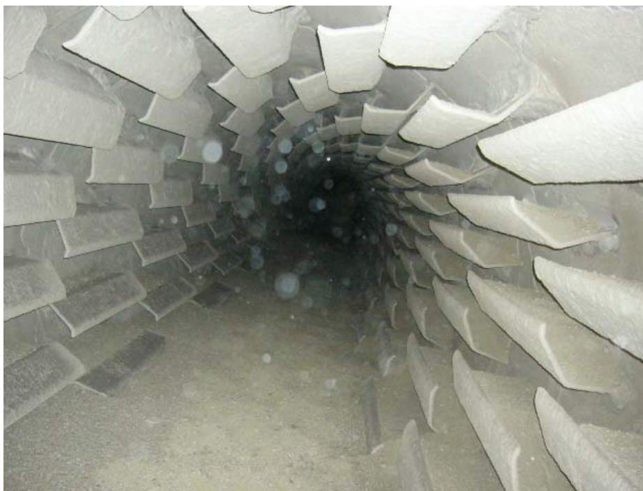
Figura 3.3: Foto interna de um secador rotatório convencional para fertilizantes granulados.
