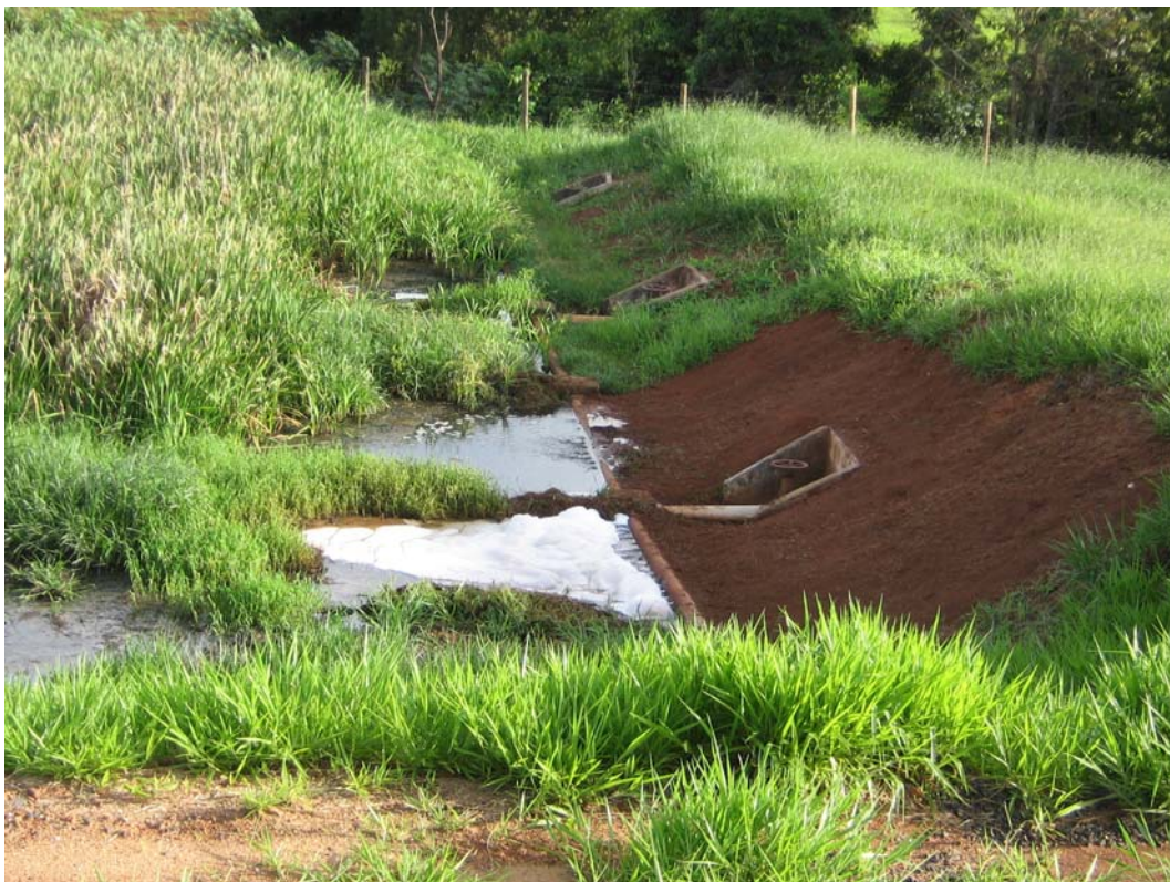
Figura 3.3 – Módulo de escoamento. Fonte: Autor.
