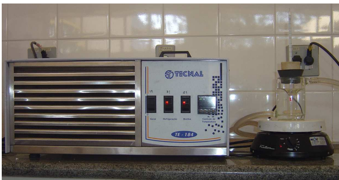
Figura 3.2 - Sistema de cristalização
