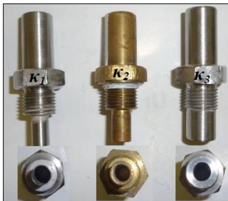
Figura 2.11 – Dutos de overflow com as diferentes espessuras de parede do vortex finder ( \kappa ) avaliadas (SILVA, 2012).
